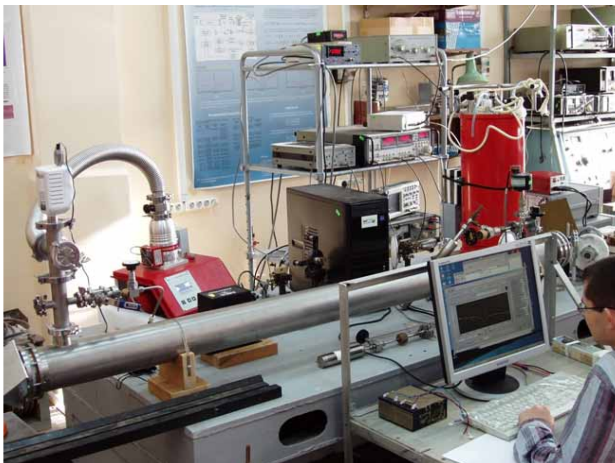
Рис. 2 Внешний вид субдоплеровского спектрометра мм и суб-мм диапазонов длин волн на основе провала Лэмба, созданного в ИПФ РАН
