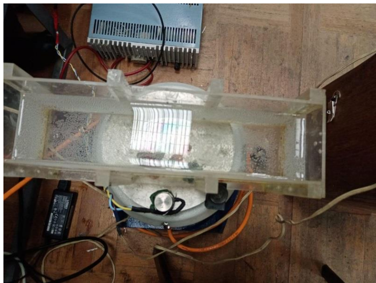
Рис. 17 Экспериментальная установка. Вибростенд и кювета с водой.
