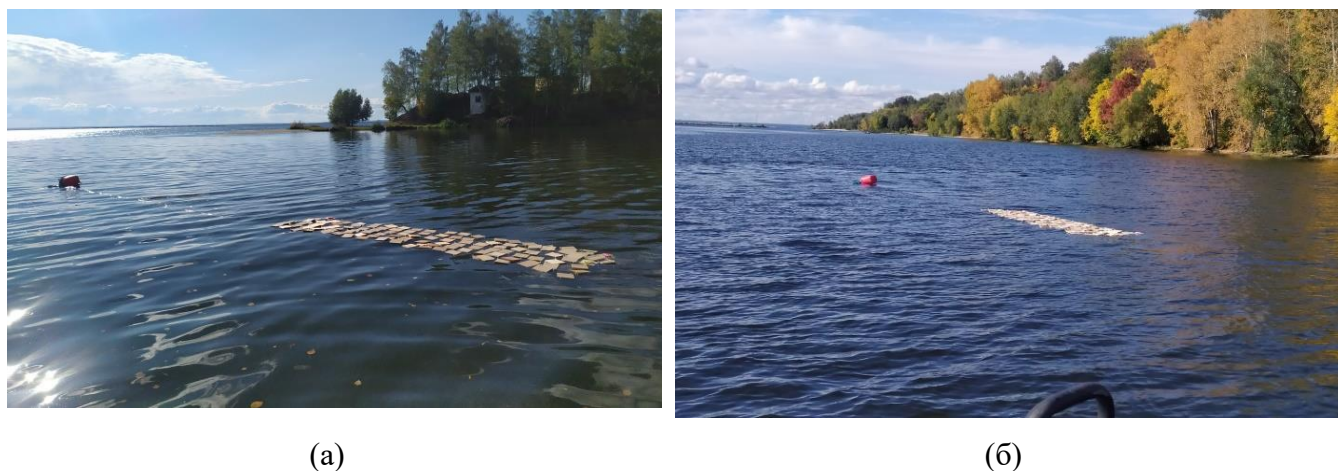
Рис 39. Фотографии поля имитаторов льдин, привязанных к заякоренному буйку вблизи яхт-клуба (а) и в аванпорте (б)
